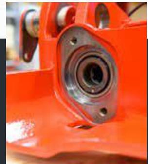
Le nouveau joint d'étanchéité haute pression au niveau du moteur hydraulique empêche les fuites et le graisseur amélioré élimine le risque de pénétration d'air dans le carter du rotor lors de la lubrification du joint de rotor.
