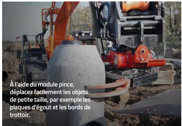
À l'aide du module pince, déplacez facilement les objets de petite taille, par exemple les plaques d'égout et les bords de trottoir.
