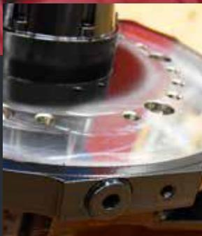
Des conduits intégrés permettent de réduire le nombre de flexibles et d'améliorer la sécurité de fonctionnement.
