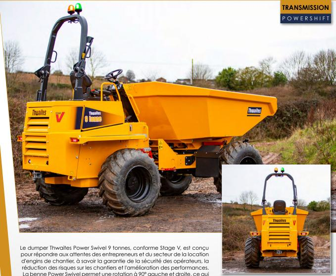
La benne Power Swivel permet une rotation à 90° gauche et droite, ce qui facilite l'accès de l'engin pour le déversement des charges en espaces restreints, améliore le contrôle par l'opérateur et réduit les risques sur les chantiers.
