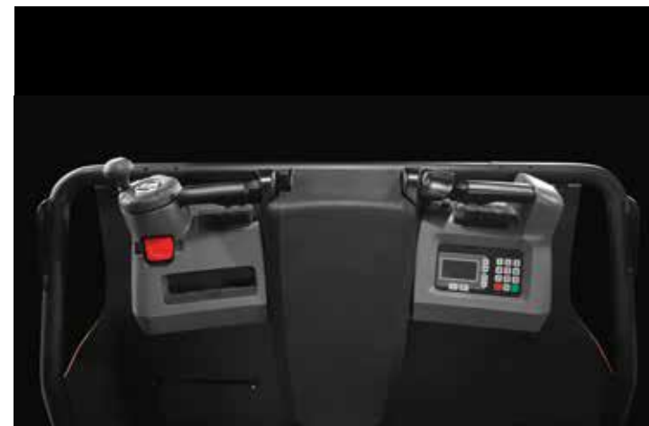
Commandes dédoublées : solution confortable et ergonomique, facilite l'accès aux fourches lors des opérations de picking
