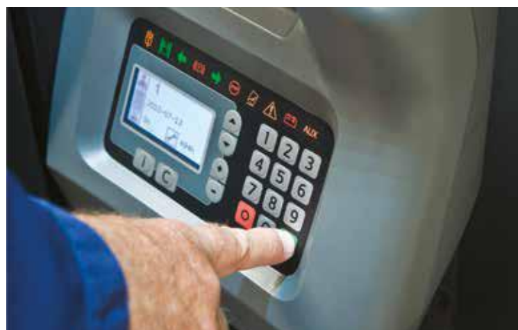
Système BT Access Control empêchant toute utilisation non autorisée du chariot et réglant automatiquement les paramètres personnels de chaque cariste au démarrage
