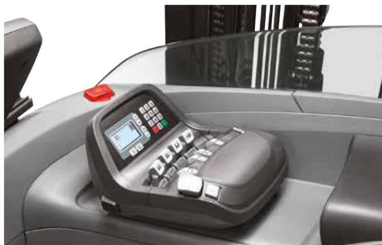
La console réglable avec mini-joysticks permet une commande précise du bout des doigts.
