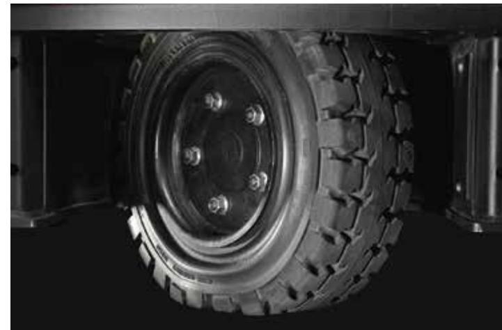
Grâce à ses roues dotées d'un bandage super élastique et à une garde au sol de 145 mm, le BT Reflex série O peut être utilisé en extérieur, notamment sur les surfaces inégales et les rampes.
