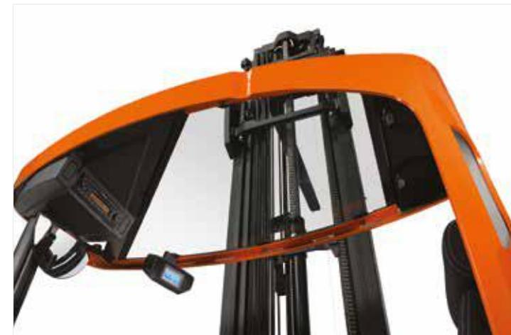
Le toit transparent offre une vue dégagée sur les fourches et facilite la manutention de charge en hauteur (option)
