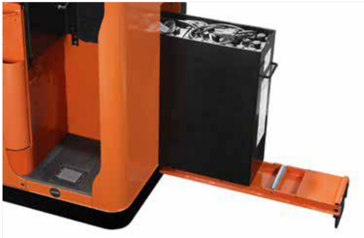
Les modèles série S sont équipés d'une batterie montée sur rouleaux avec table de remplacement de batterie intégrée, pour une extraction latérale aisée de la batterie
