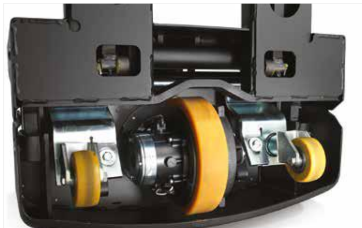
Le système unique de liaison des roues stabilisatrices les protège sur les surfaces inégales
