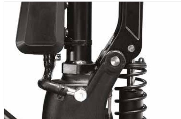
Système de levage hydraulique
