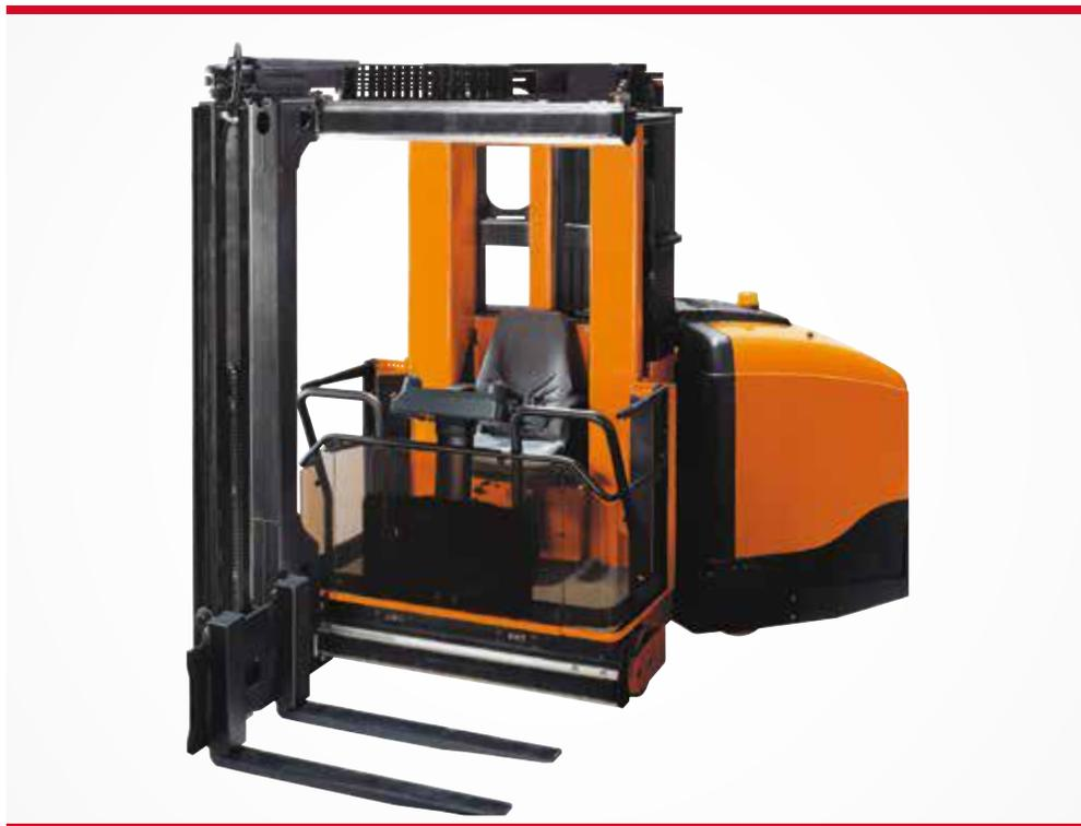
Chariots à châssis articulé pour la préparation de commandes à grandes hauteurs et la manutention de palettes pleines, offrant une optimisation de l'espace de stockage propre aux modèles pour allées étroites.
