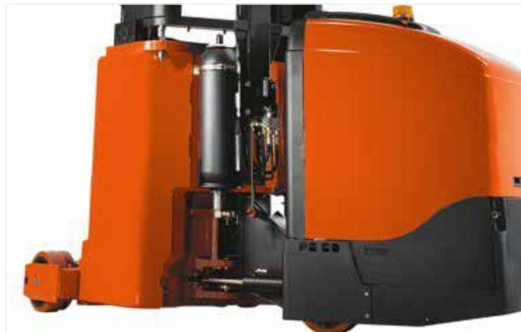
Les BT Vector sont dotés d'un système de levée (ALS) innovant. A la clé, une consommation réduite de l'énergie de la batterie, ce qui permet à 2 équipes de travailler avec une seule charge
