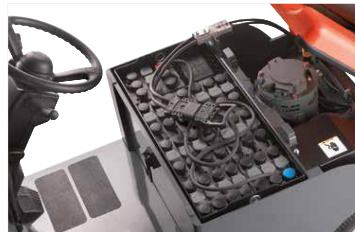
Le 4CBTY offre une grande facilité d'accès à la batterie.
