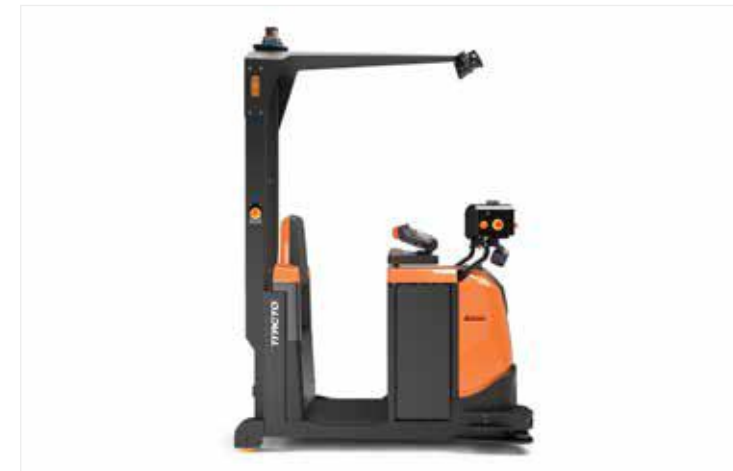
Les chariots tracteurs automatisés Autopilot TAE500 prennent en charge des tâches répétitives, entre les lignes de production et les zones de stockage ou les systèmes de convoyeurs.
