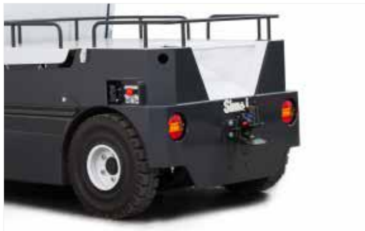
Boutons de marche lente pour reculer lentement le chariot tracteur et l'accrocher au support de charge.
