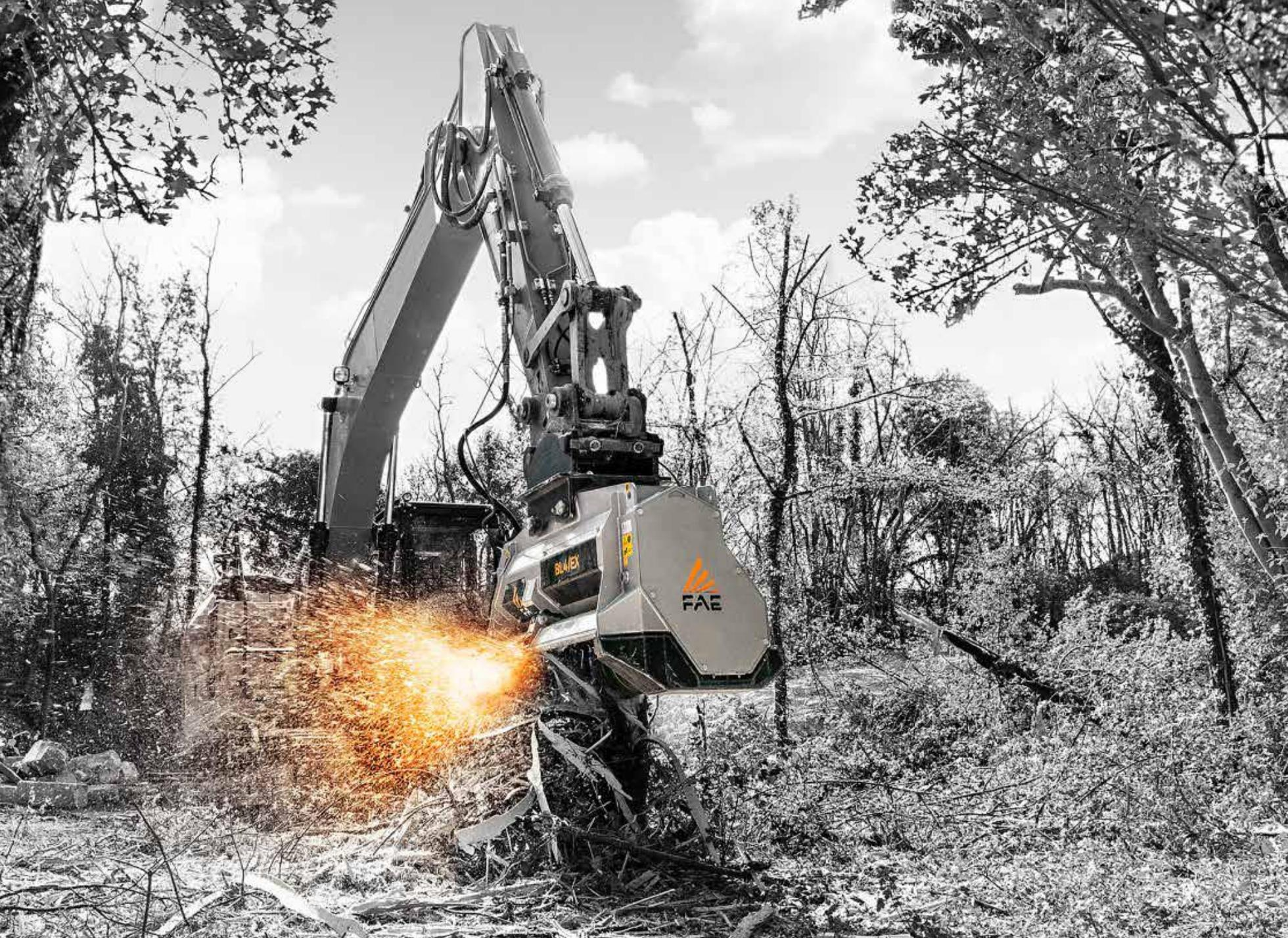
BROYEURS À TRANSMISSION HYDRAULIQUE
