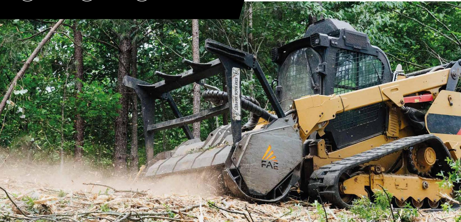
BROYEURS À TRANSMISSION HYDRAULIQUE
