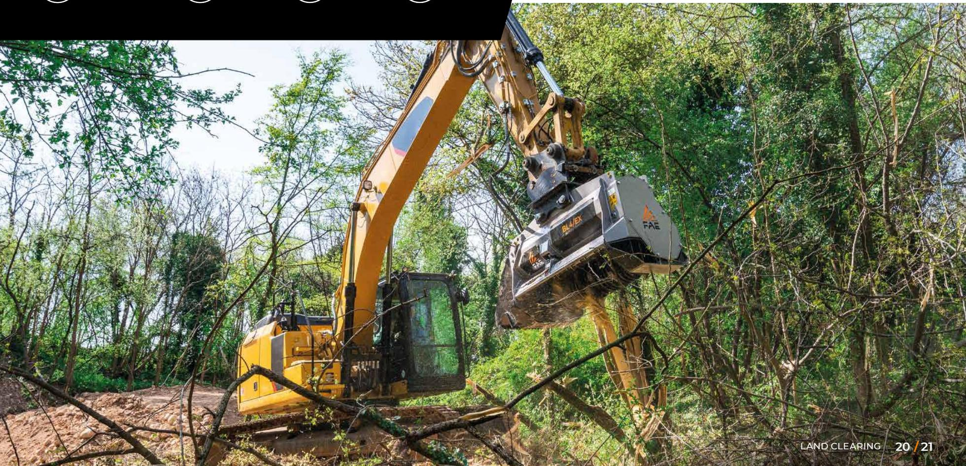
BROYEURS À TRANSMISSION HYDRAULIQUE
