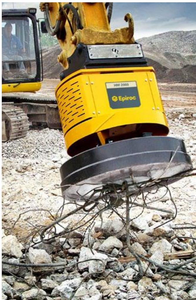
Grâce à leur facilité d'installation, les aimants hydrauliques sont idéaux pour les sites de démolition, les parcs à ferraille et les sites de recyclage.
