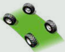
Mode 2 roues : essieu directionnel avant
