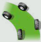
Mode 4 roues : essieux avant et arrière directionnels
