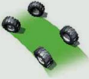
Mode 2 roues : essieu directionnel avant
