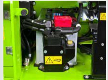
Pour augmenter l'efficacité et la durée de vie des batteries, les ROTO sont équipés, de série, d'un disjoncteur électrique et automatique de batterie. Lorsque le circuit est déconnecté, il suffit d'insérer les clés dans le panneau de contrôle pour réactiver les batteries.
