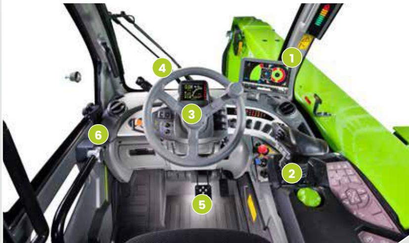
Une nouvelle conception privilégie la fonctionnalité et le confort ; les informations et les commandes des différents systèmes et dispositifs sont regroupées pour maximiser l'ergonomie. L'inverseur au volant est également dupliqué sur le joystick.
