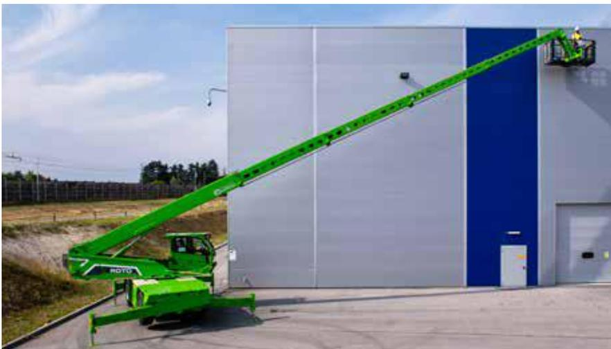
Bras composé d'une double section en « C » en acier à haute résistance avec des soudures réalisées le long de l'axe neutre de flexion. Des flexibles hydrauliques et des câblages électriques, placés à l'intérieur du bras, garantissent une protection contre les éventuels impacts. Ces caractéristiques offrent :
