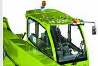
Une structure métallique, placée sur le toit en verre, permet d'obtenir l'une des certifications les plus strictes en matière de protection : la FOPS de niveau II. Cette reconnaissance constitue une garantie en termes de :
