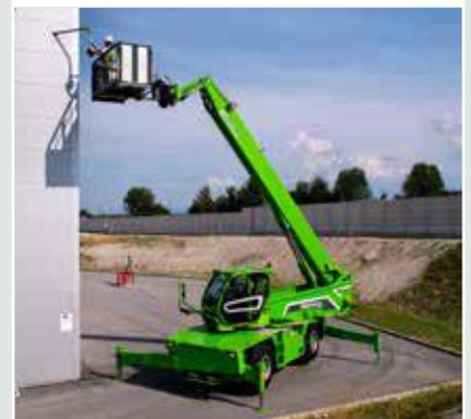
Les modèles présentant des hauteurs de levage supérieures à 20 mètres, sont équipés de stabilisateurs qui peuvent être positionnés avec n'importe quelle extension, en adaptant le plan de stabilité à la zone de travail disponible.
