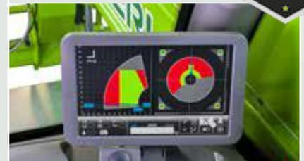
Le système ASCS permet à l'opérateur de fixer les vitesses des mouvements hydrauliques et de gérer les limites géométriques dans lesquelles il peut travailler avec le bras en toute sécurité. Jusqu'à 6 configurations différentes sont également disponibles.
