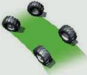
Mode 2 roues : essieu directionnel avant
