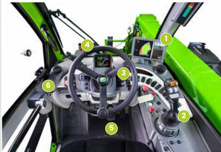
Une nouvelle conception privilégie la fonctionnalité et le confort ; les informations et les commandes des différents systèmes et dispositifs sont regroupées pour maximiser l'ergonomie. L'inverseur au volant est également dupliqué sur le joystick.
