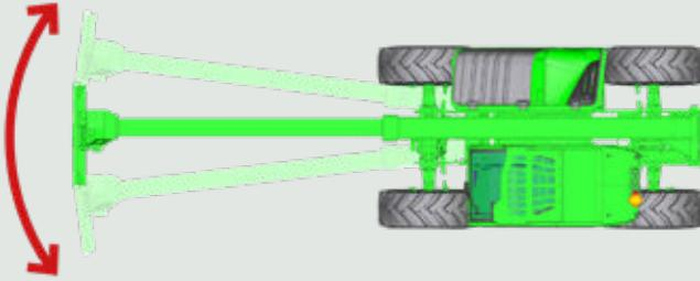
Système intégré dans le châssis de la machine qui permet un mouvement latéral de la flèche télescopique, assurant un positionnement précis de la charge sans avoir recours à d'autres manœuvres, ce qui permet de gagner du temps, d'éviter le stress et d'améliorer la productivité de la machine.
