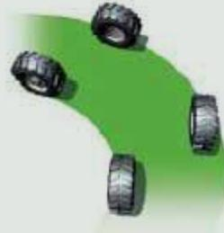
Mode 4 roues : essieux avant et arrière directionnels
