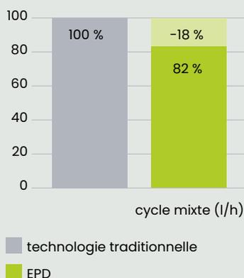
Système exclusif et innovant EPD (Eco Power Drive) pour le contrôle électronique du moteur et de la transmission. L'EPD contrôle et ajuste automatiquement le régime moteur en fonction des conditions de fonctionnement, permettant une réduction de la consommation de carburant jusqu'à 18 %. Permettant ainsi d'économiser jusqu'à 3 300 € par an (donnée obtenue sur la base d'une utilisation moyenne de 1 000 h/an et d'un coût moyen du carburant de 1,1 €).
