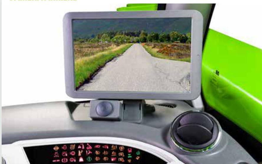
En combinaison avec le tableau de bord 10,1" du système ASCS, il est possible d'équiper la machine d'une caméra arrière à activation automatique, avec l'activation de la commande de marche arrière. Les images provenant de l'arrière du chariot télescopique sont affichées directement sur le tableau de bord de la cabine.
