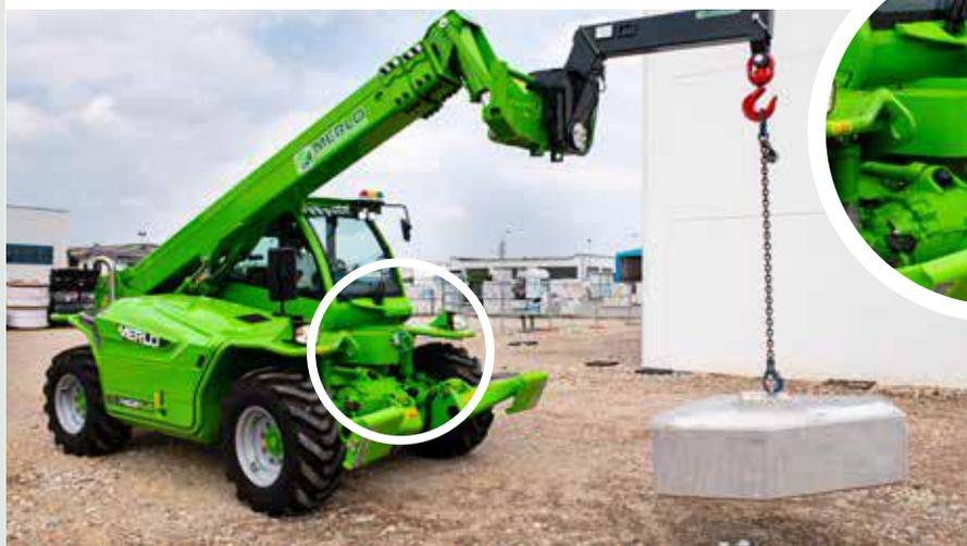
Pour augmenter l'efficacité et la durée des batteries, les chariots télescopiques stabilisés sont équipés de série d'un disjoncteur de batterie manuel en position frontale, facile à atteindre pour pouvoir désactiver le circuit quand on prévoit de longs arrêts de son chariot télescopique.
