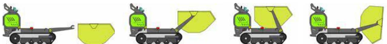
L'attelage rapide breveté, qui équipe le châssis porteur de deux solides bras mécaniques, est la base technologique du Cingo multifonction. Une grande partie des équipements du système multifonction sont compatibles avec ce dispositif.
